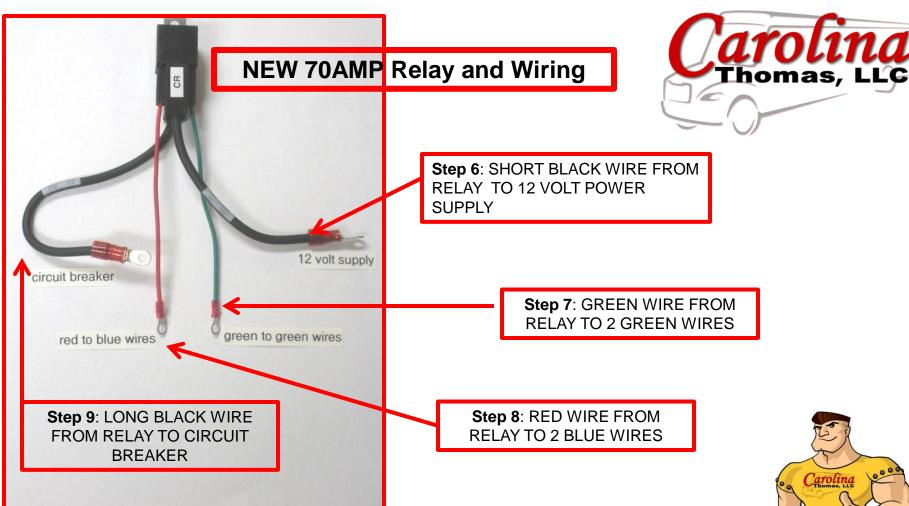
SHORT BLACK WIRE FROM RELAY TO 12 VOLT POWER SUPPLY LONG BLACK WIRE FROM RELAY TO CIRCUIT BREAKER GREEN WIRE FROM RELAY TO 2 GREEN WIRES RED WIRE FROM RELAY TO 2 BLUE WIRES
